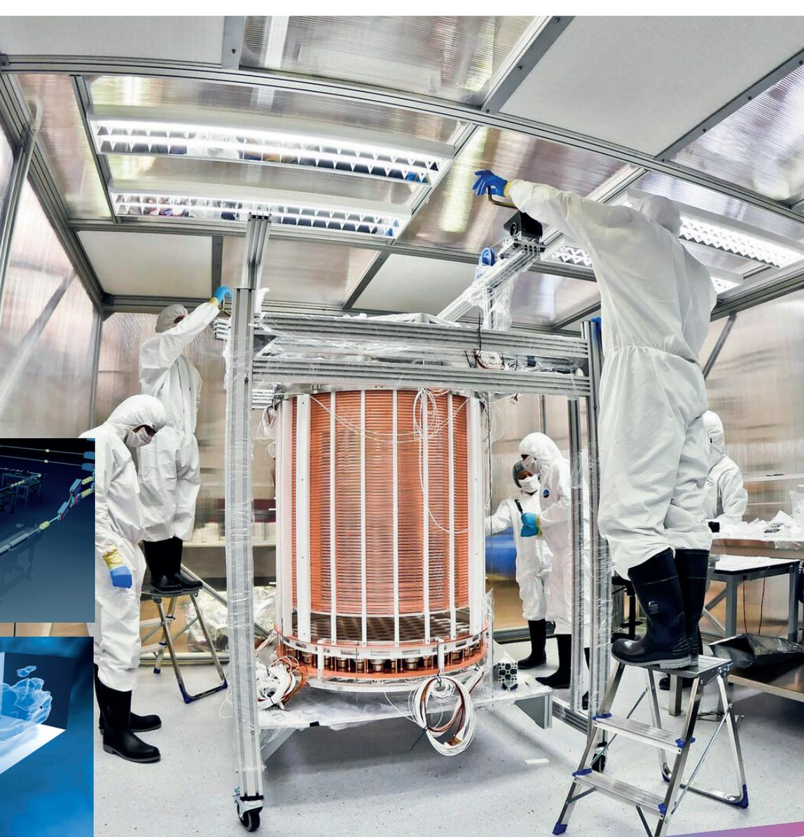
Die Suche nach Dunkler Materie (Bild unten: 3D-Karte einer Verteilung auf Basis von Hubble-Daten) bei PRISMA<sup>+</sup> ist facettenreich: Das XENON Experiment (großes Bild: innerer Detektor) und der neue Teilchenbeschleuniger MESA (Bild oben) haben zum Ziel, sie zu finden.
